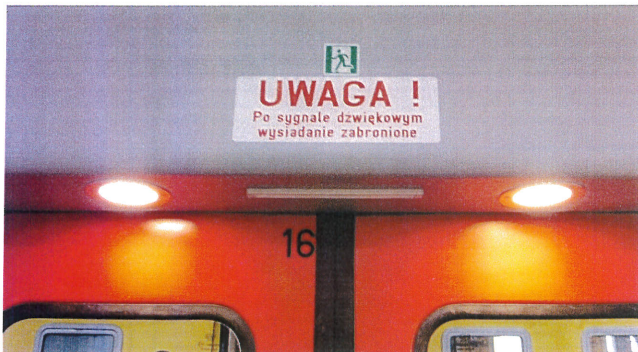
Fotografia nr 1. Oświetlenie LED zamontowane na klapach inspekcyjnych drzwi automatycznych.
